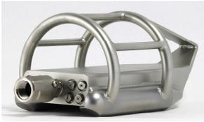
La buse **SCRAPER** utilise un circuit optimisé par études hydromécaniques pour convertir l'eau du tuyau sous pression en une puissance de nettoyage sans égale. Les barreaux cylindriques permettent à la buse de se redresser d'elle-même dans la conduite. Tous les jets arrière sont concentrés à la base.
