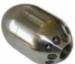
Buse **Tri-Jet** de nettoyage haute performance pour le nettoyage cyclique de la canalisation avec le système de guidage d'eau 3D. Les 3 niveaux de faisceau de 7°, 14° et 21° ou 16° et 26° confère à la buse **Tri-Jet** 3D des caractéristiques de nettoyage optimales.
