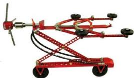
**Eibow:** Appareil de nettoyage spécialement conçu pour les profils ovoïdes. Applicable pour profil ovoïde jusqu'à une hauteur de 2400 mm. Réglage en continu du traîneau sans outils. Nettoyage à travers la totalité de la section transversale 360° en un passage de rinçage. Facile à introduire dans des ouvertures de puits de 500 mm et immédiatement commencer avec le processus de nettoyage.
