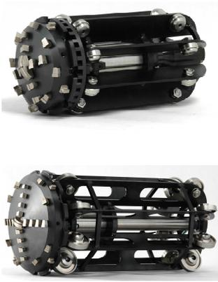
Ces fraises innovantes sont construites en acier inox trempé et offrent une grande efficacité de rotation et de poussée. La pièce d'entraînement elle-même est en acier inox trempé comprenant un arbre d'entraînement et deux roulements doublement scellés. Cela élimine le recours à un moteur hydraulique et ainsi le besoin de lubrifier, ce qui assure des années d'utilisation avec un entretien réduit.
