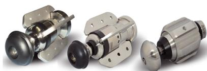
La buse **PRIMUS** est une buse de nettoyage de réseaux d'assainissement à vitesse de rotation contrôlée. La buse est entraînée par l'eau issue d'un tuyau sous pression. Le contrôle de la vitesse de rotation est réalisé par l'angle d'incidence des jets en conjonction avec des disques d'embrayage internes en céramique de haute performance.
