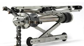
APPLICATIONS - Enlever les occlusions importantes par racines et les obturations totales / Enlever les incrustations et les dépôts (calcaire, ciment, plaques, croûtes, graisses durcies, etc.)
