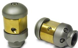
La buse **ROCKER** est une buse de nettoyage d'égout vibrante. D'aspect similaire à la buse rotative, elle est capable d'éliminer les dépôts les plus tenaces du fond des conduites DN 100 à 600 mm. La rotation désaxée du rotor cause des vibrations agressives qui cassent les dépôts.
