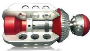
Buse rotative **TURBINATOR** de haute performance apte à l'eau recyclée. 2 différents angles de projection dans la tête de rotation. L'anneau frontal nettoie directement sur la paroi du tube. L'anneau arrière est dérivé par la roue d'entraînement et provoque un effet de pulsation, qui conduit à un nettoyage efficace sans laisser des traces.
