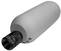
La buse **SPEED POWER** est une buse ovoïde, très efficace pour le nettoyage des radiers de canalisations avec poids pendulaire, un angle de jets de 7°, idéale pour les pierres, les éboulis, les boues, grande capacité d'emport des déchets.
