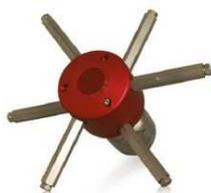
La buse **Spin-Jet** est conçue pour le curage des puits d'accès et des regards d'égouts avant réhabilitation. L'Alphajet est mue par l'eau fournie par le tuyau sous pression du camion hydrocureur. Quatre buses motrices entraînent la rotation à 360° dans un plan horizontal, deux buses oscillantes dans un plan vertical complètent le nettoyage.
